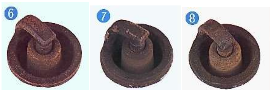
3-5 Vysoká tepelná hodnota svíčky, špatné chlazení, bohatá směs
