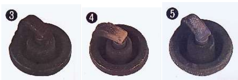
3-5 Vysoká tepelná hodnota svíčky, špatné chlazení, bohatá směs
