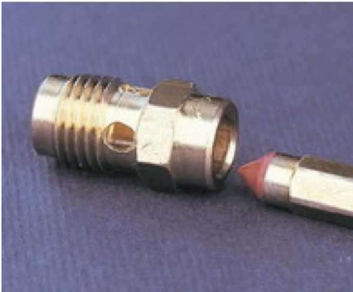
Plováková komora, plovák, plovákový ventil
